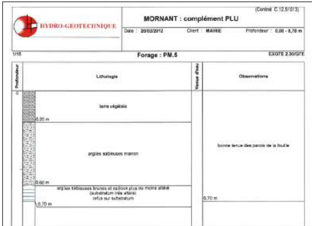
Figure 15 : Fouille à la pelle mécanique PM5, dans le secteur de Berne, extrait de l'étude géotechnique G11 de 2012 [Source : HYDROGÉOTECHNIQUE]
